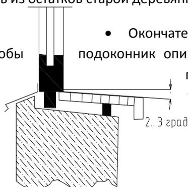
на него какой-нибудь груз, например наполненные водой банки, чтобы расширяющаяся пена не «выдавила» подоконник вверх.
